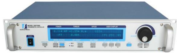
двигателя. Разработанный для использования с любым гистерезисным, индуктивным или магнитопорошковым динамометром Magtrol, Magtrol In-Line датчиком крутящего момента или дополнительным оборудованием, DSP7000 может обеспечить полный контроль с ПК через интерфейсы IEEE-488 или RS-232. Со 500 измерениями в секунду DSP7000 идеально подходит как для испытательной лаборатории, так и для производственной линии.
